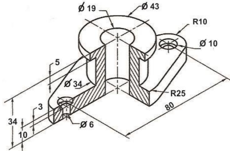
**Ejercicio 3:** Dadas las vistas de alzado, planta y lateral izquierdo de una pieza según el método de proyección del primer diedro a escala 1:2, acotar según norma ISO las medidas necesarias para definir completamente la pieza.
