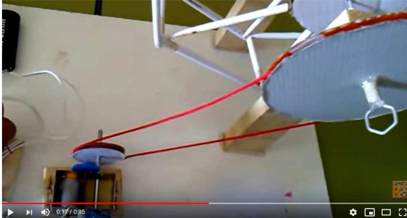
Observar reductora, polea, correa roja, y polea grande (poleas de color gris azulado)
